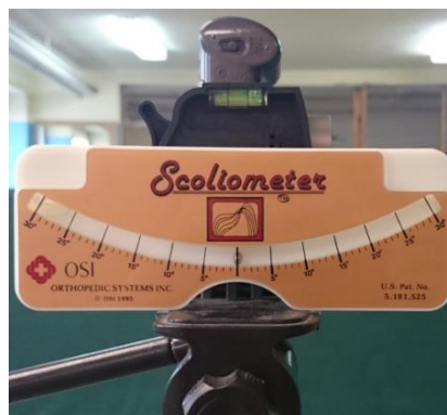
Rycina 2. Wypoziomowanie aparatu na statywie z użyciem skoliometru Bunnella.
